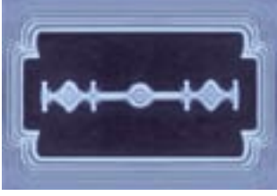
الشكل (١٤): حيود الضوء حول حواف شفرة حلاقة
