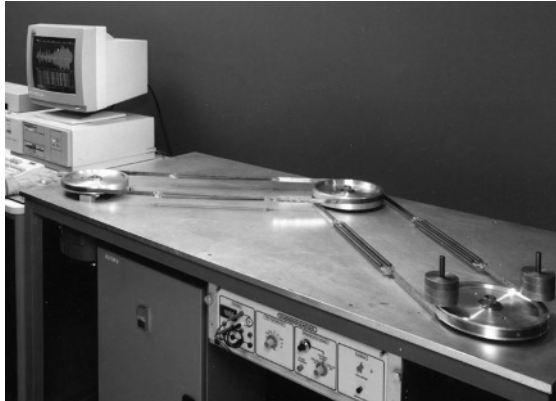
Figure 7.20. View of the flexible transmission (Laboratoire d'Automatique de Grenoble INPG/CNRS/UJF)
