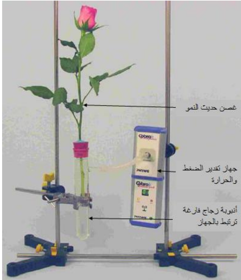
شكل ( 18 ) تقدير النتح عن طريق تقدير التغير في جهد الضغط ، عن TESS
