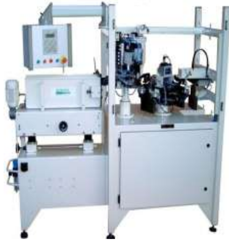
شكل 7.18. ماكينة تصنيع البذور الصناعية بعد ان تُلقم بأجنة جسمية سبق وان أنتجت نسيجياً أو داخل مُفاعلات حيوية.
