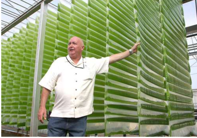
شكل 12.9. مفاعل حيوي من طبقة واحدة عمودي مُخصص لتربية الطحالب داخل مُنشآت مُسيطر على ظروفها البيئية.
