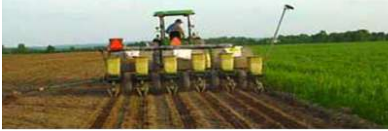
شكل 7.25. باذرة ميكانيكية تُستعمل لبذر البذور الطبيعية أو الصناعية على نطاق واسع.
