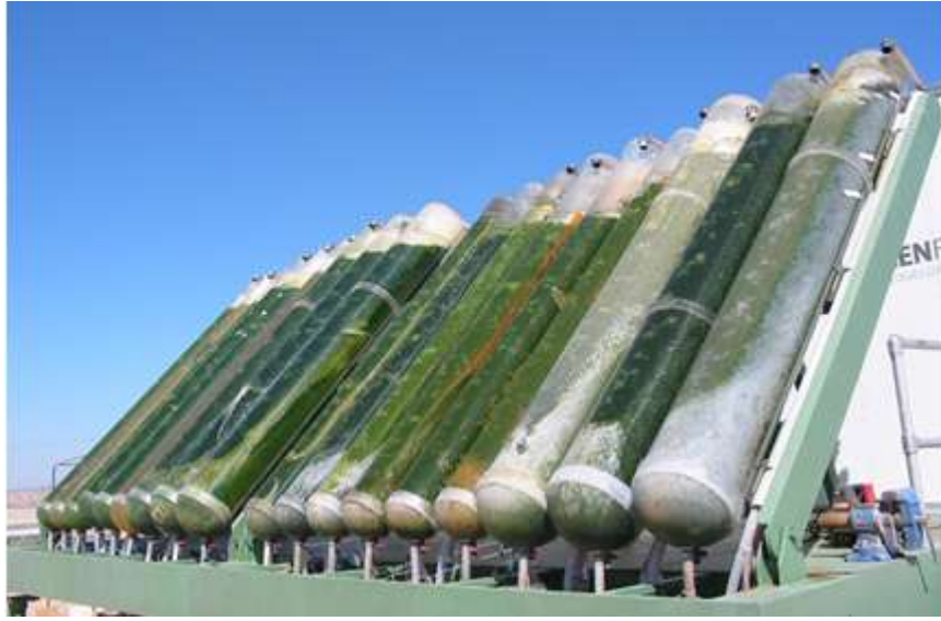
شكل 12.10. مفاعلات حيوية لتربية الطحالب مُتحركة بنظام هيدروليكي لإستلام أكبر كمية من أشعة الشمس الساقطة.
