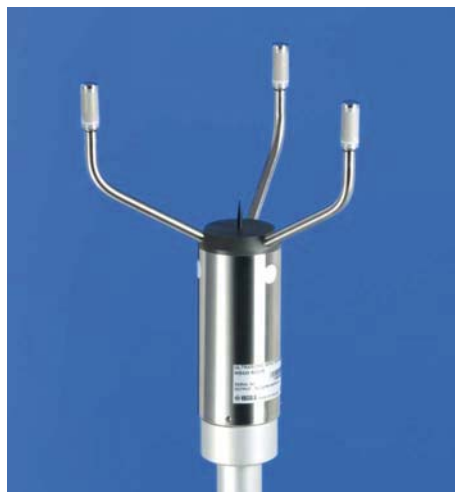
Fig. 3.11. Sonic anemometer (Courtesy of Vaisala Oyj, Vanha Nurmijärventie 21, FIN – 01670, Vantaa, Finland, www.vaisala.com )
